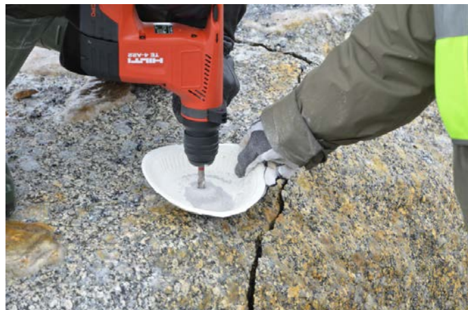
Kuva 2. Pirkanmaan POSKI-projektin kallioperänäytteet otettiin ASROCKS-hankkeessa kehitetyllä poravasaramenetelmällä. Kuva: Jouko Vuokko.
