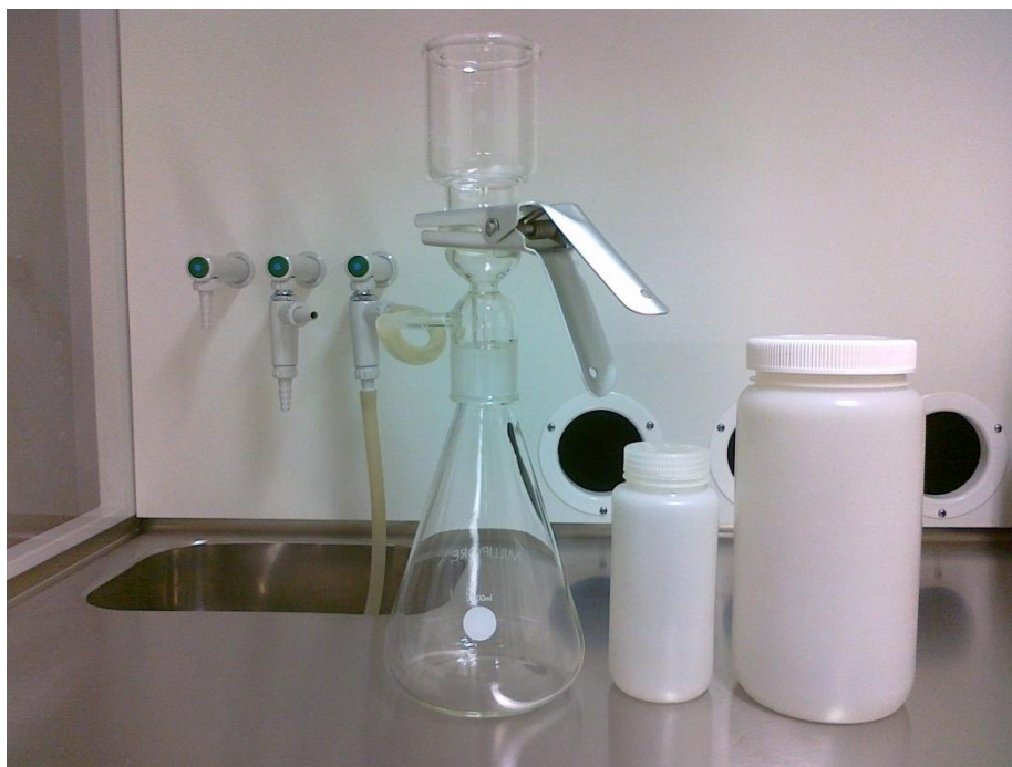
Kuva 2. Liukoisuustestien suodatuksissa käytetty imusuodatuslaitteisto sekä ravistelutestin pullot.
