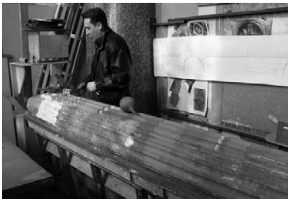
Рис. 42. Момент работы над новой колонной главного иконостаса. Видны металлическая труба, слой стюка, раскраска и груша-распылитель пигментов. Фото А. Г. Булаха. 2004 г.
