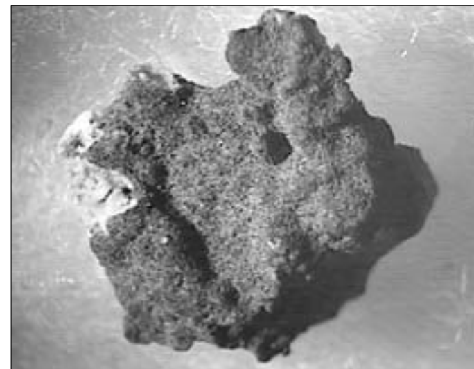
Рис. 48. Вид и строение чёрной плёнки под небольшим увеличением (фото через оптический бинокулярный микроскоп Leica). Ширина образца — 7 мм. Материалы А. Г. Булаха. 2012 г.
