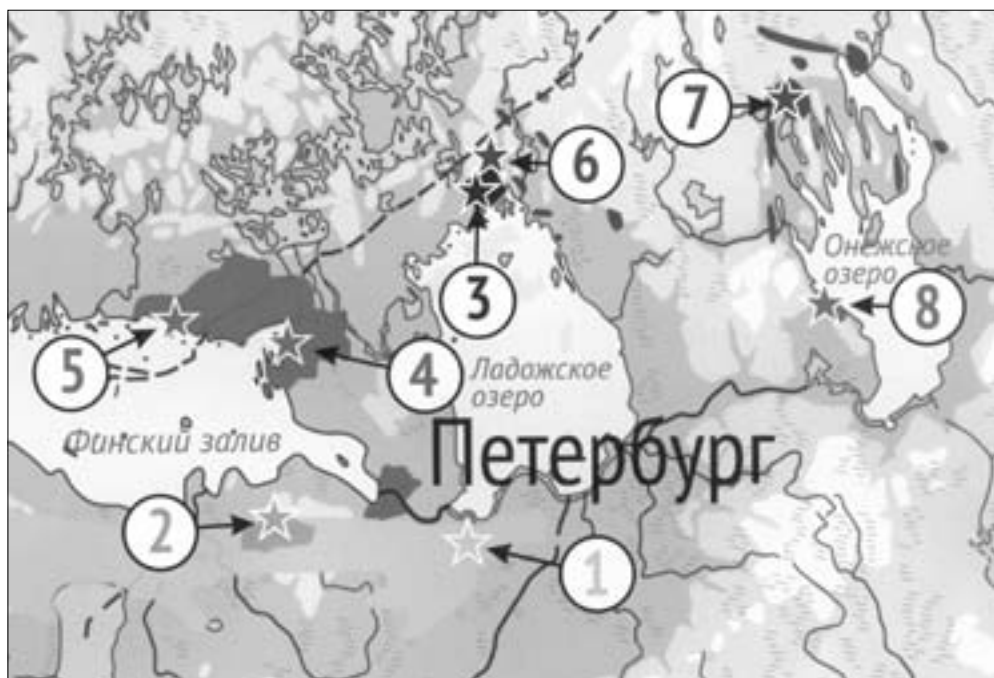
Рис. 10. Места добычи цветного строительного камня для Казанского собора: 1 – тосненская и путиловская известняковая плита, 2 – пудостский известковый туф, 3 – сердобольский гранит, 4 – гранит рапакиви (Монрепо), 5 – Фридрихсгамская гранитная ломка, 6 – рускеальский мрамор, 7 – тивдийский мрамор, сланец 8 – шокшинский кварцит. Составил Г. Попов (2012) с использованием материалов З.С. Зискинда (1989). Географическое положение точек указано ориентировочно
