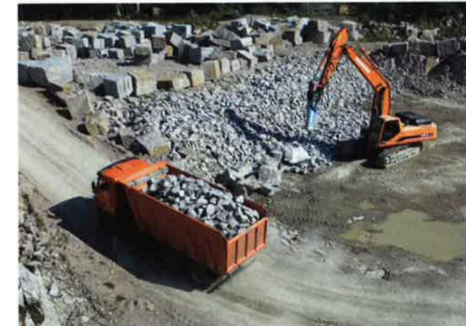
**Фото 81-85. Месторождение Ладожское – промышленный карьер, в котором добывают гранитные блоки по буро-взрывной технологии. Из отходов от добычи блоков при помощи гидромолота получают калиброванный окол.**
