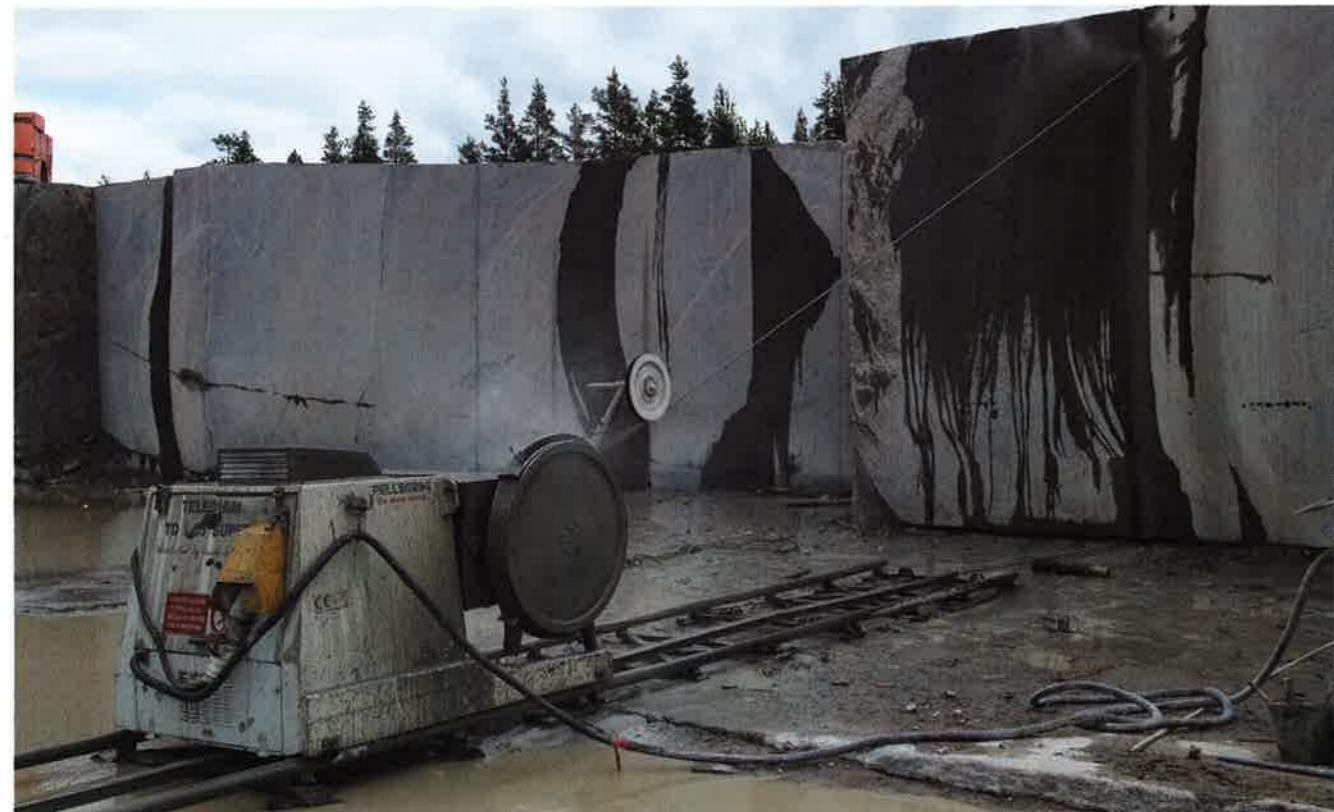
Фото 87. Месторождение Балтийское – промышленный карьер облицовочного камня: граносиениты добывают с применением технологии алмазо-канатного пиления
