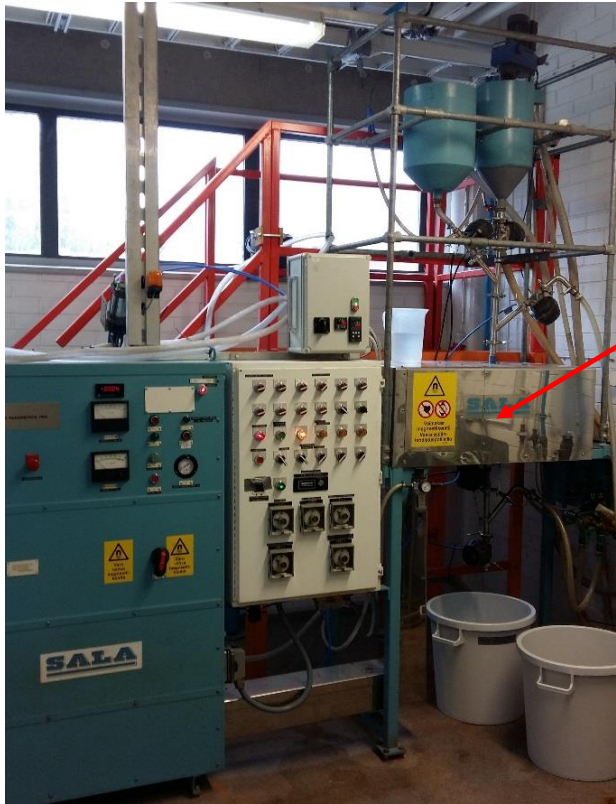
Vahvamagneettinen suurgradienttieroitin (HGMS) GTK Mintecissä
