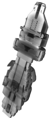
Poraistukka ja goniometri, halkaistu 3D – visualisointi.
