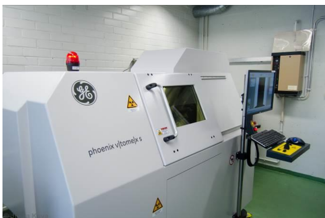
Tomografialaite GTK:n laboratoriossa.
