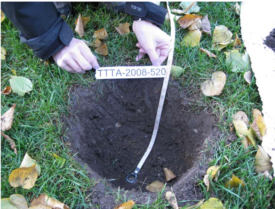
Kuva 4. Esimerkki 25 cm:n näytekoupastä Tampereen Eteläpuistossa.
