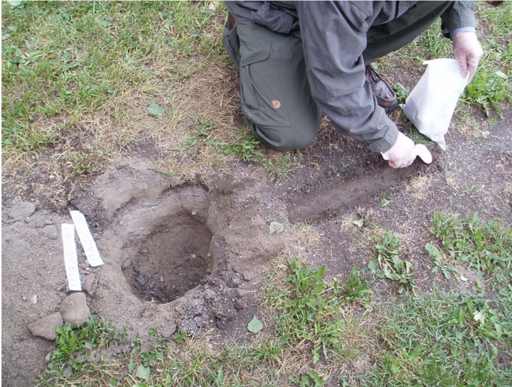
Kuva 3. Näytteenottoa Tampereen Eteläpuistossa. 0-25 cm näyte on otettu lapiolla kaivetusta kuopasta nurmikon alta ja 0-2 cm näyte on otettu näytteenottokauhalla kohdasta, jossa nurmikko on kulunut pois.
