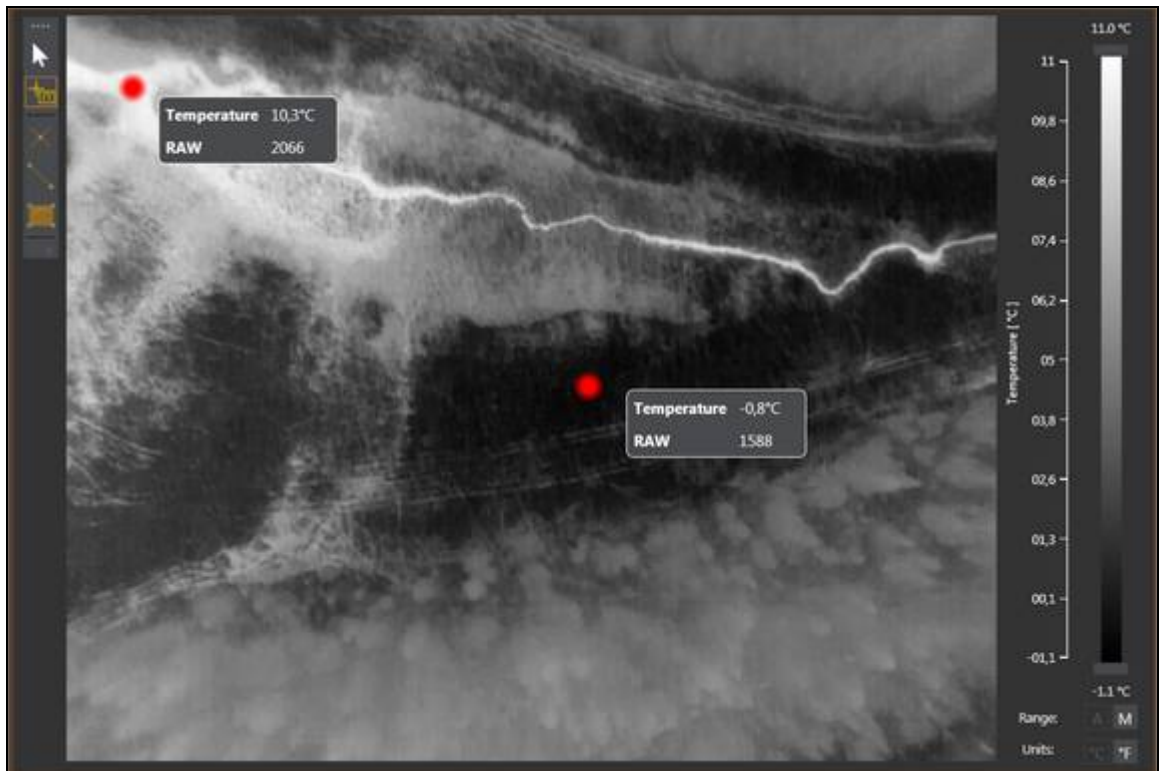
Kuva 9. Sama lennon nro 22 lämpökuva avattuna ThermoFormat-ohjelmaan, jossa voidaan tarkastella lämpötiloja pikseli kerrallaan myös RAW-muodossa.
