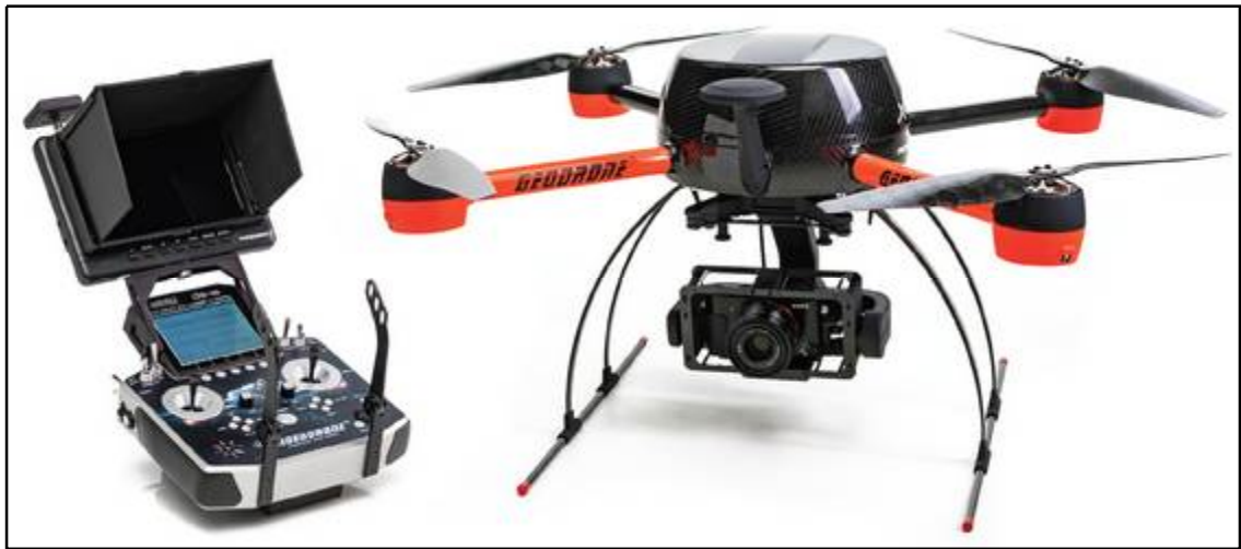
Kuva 1. GeoDrone X4L –kuvauskopteri radio-ohjauslaitteineen.
