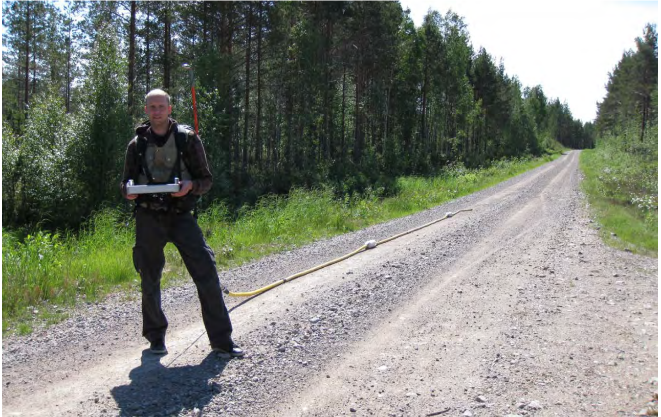
Kuva 7: Geologian tutkimuskeskuksen ns. letkututkalaitteisto (Kuva:E.Lindsberg/GTK)
