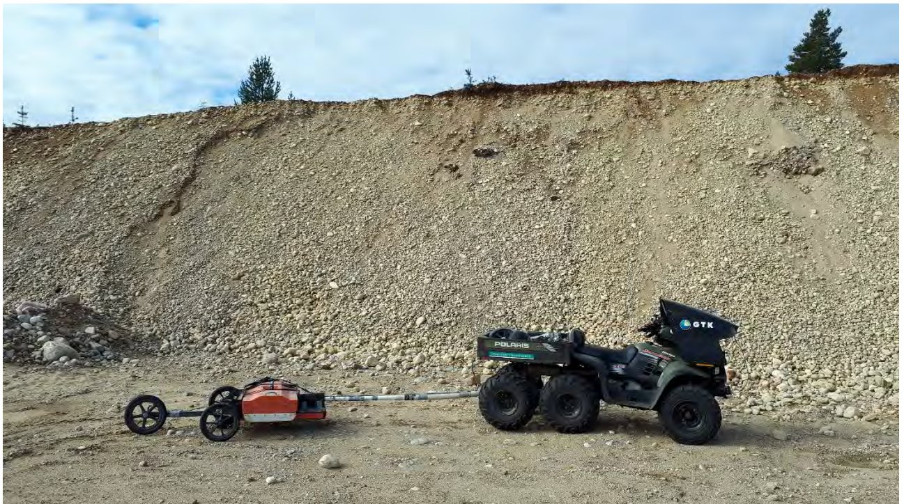
Kuva 6: Lapin POSKI II- projektin yhteydessä mönkijällä vedettävä maatutkaluotauslaitteisto.
