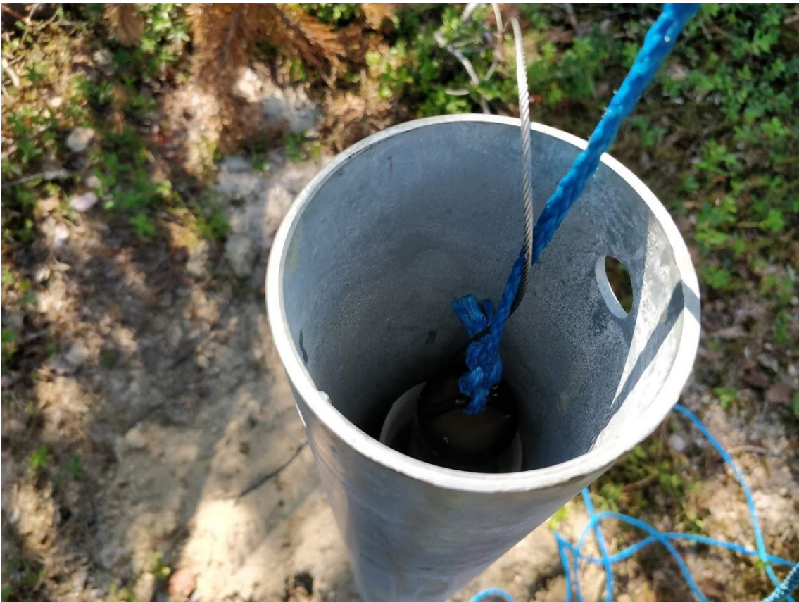
Kuva 9. Pinnankorkeuden mittarin vaijeriin takertunut baileri. (Kuva: Riku Sanaksenaho)
