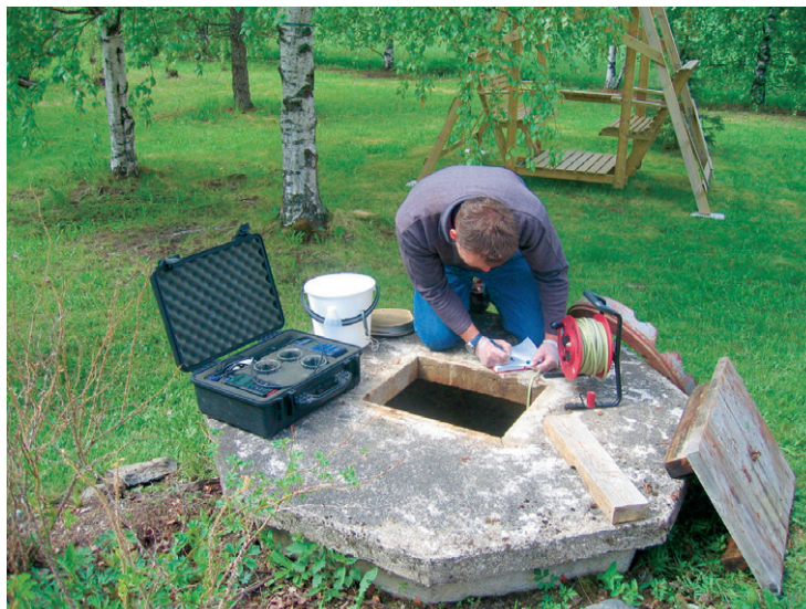
Kuva 19. Pohjavesinäytteenotto kaivosta Pirkanmaalla. Kuva Arto Pullinen.
